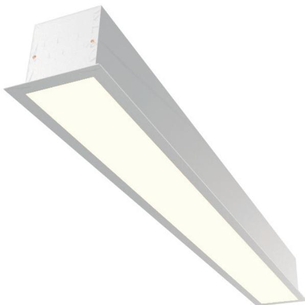
Luminaria de embutir de dimensiones reducidas fabricada en aluminio ALUAR con difusor acrílico opal. Iluminación provista por tiras led TRIANO con eficiencia de 130 lúmenes por watt.
