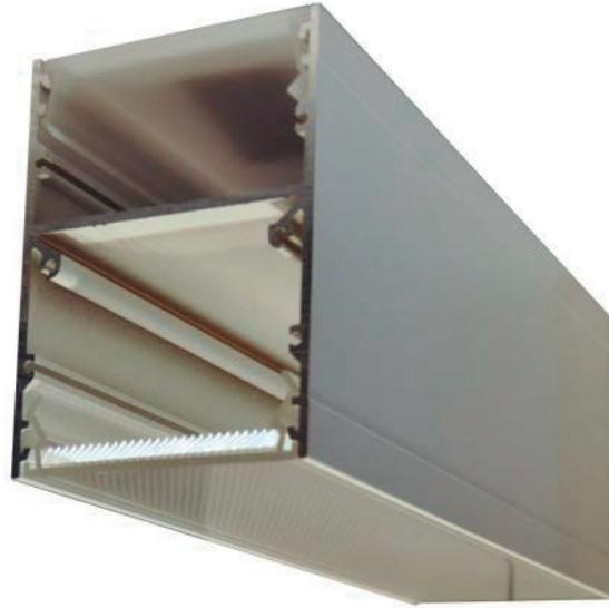
Luminaria suspendida fabricada en aluminio ALUAR con difusor acrílico opal. La iluminación directa es provista por tiras led TRIANO con eficiencia de 130 lúmenes por watt mientras que la indirecta por tiras led Epistar 2835. Driver HELVAR, posibilidad de dimerizar con protocolo DALI. La potencia indicada para las placas representan el máximo, las mismas pueden ser ajustadas bajo pedido.
