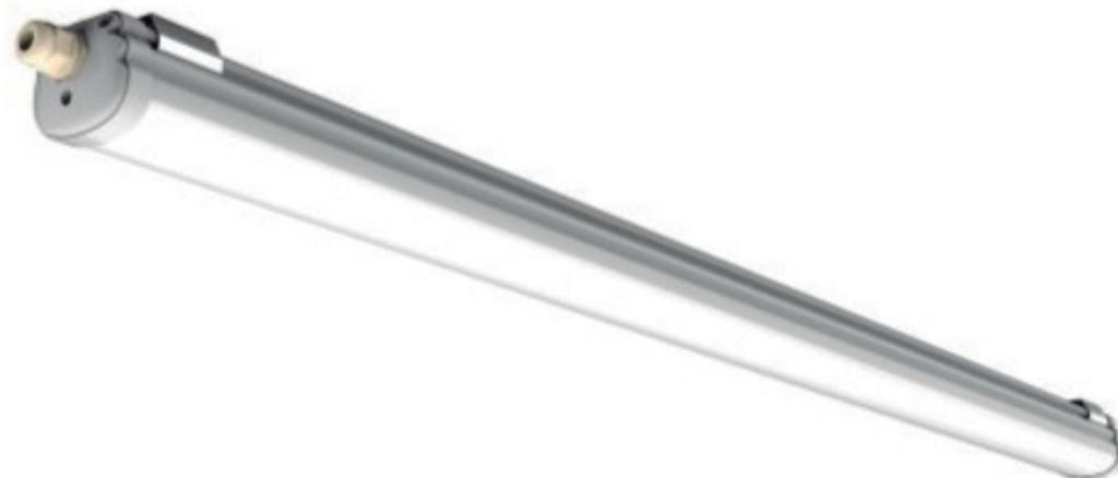
Artefacto de aplicar o suspender con carcasa de policarbonato blanco y difusor de policarbonato opal. Cuenta con una distribución de iluminación directa - simétrica y un acabado realizado en pintura polvo poliéster. Grado de protección IP 65, IK 08.
