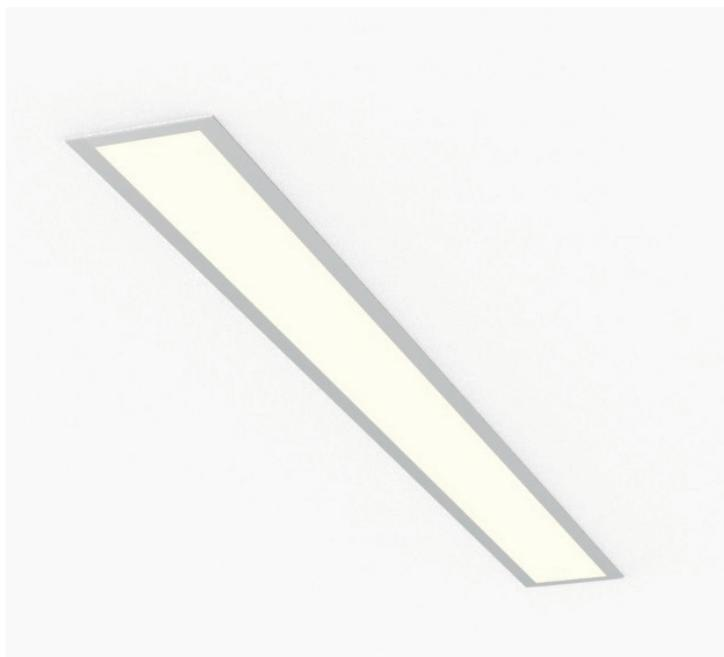
Luminaria de embutir ancha de corta altura, fabricada en aluminio ALUAR con difusor acrílico opal. Iluminación provista por tiras led TRIANO con eficiencia de 130 lúmenes por watt. Driver HELVAR, posibilidad de dimerizar con protocolo DALI. Cuenta con perfil en L para continuar el artefacto tanto en pared como en techo. La potencia indicada para las placas representan el máximo, las mismas pueden ser ajustadas bajo pedido.
