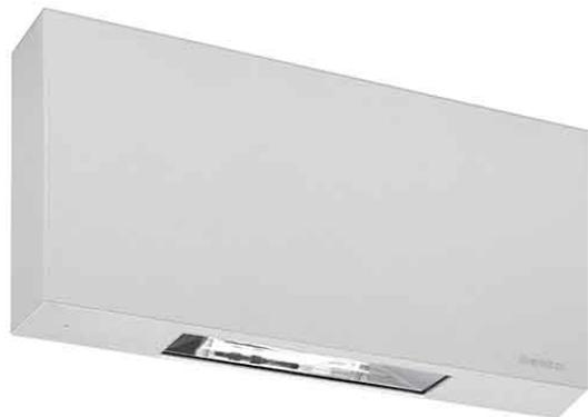
**TIPO DE PRODUCTO:** Cuerpo rectangular en aluminio de reducidas dimensiones compuesto por un conjunto óptico formado por reflector aluminizado y difusor en policarbonato. Consta de un LED como fuente de luz que se ilumina si falla el suministro de red.
