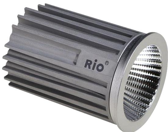
**TIPO DE PRODUCTO:** Lámpara LED**CUERPO:** de aluminio inyectado**DIFUSOR:** Anti-deslumbrante de aluminio.**DISTRIBUCIÓN DE LUZ:** Directa- simétrica**OPCIÓN:** Dimerizable**IP:** 20**ENTRADA:** 220 – 240 Vca, 50/60 hz**ANGULO DE APERTURA:** 38°**POTENCIA:** 9 W**TEMPERATURA DE COLOR:** 3000/4000 K**CRI:** 90
